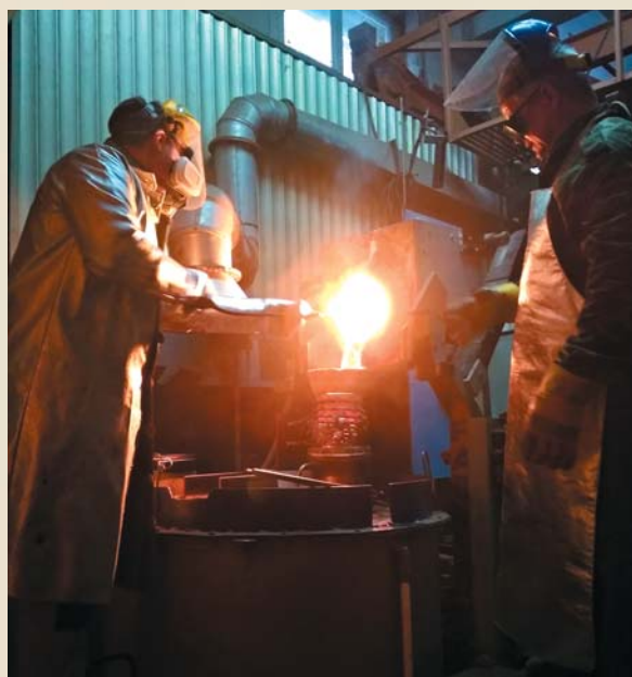
Лабораторная установка для разработки технологий получения порошков сталей и сплавов
